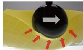
エクスジェルクッションは縦方向だけでなく横方向にも柔軟に変形する。この特性により、身体の動きを妨げず皮膚へのストレスも軽減する。
