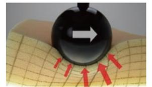
ウレタンフォームは縦方向には潰れやすいが、そこから水平方向には変形しにくい。座面に加わる力は常に縦方向と横方向の力の組み合わせで、皮膚にストレスが掛かり続ける場合もある。
